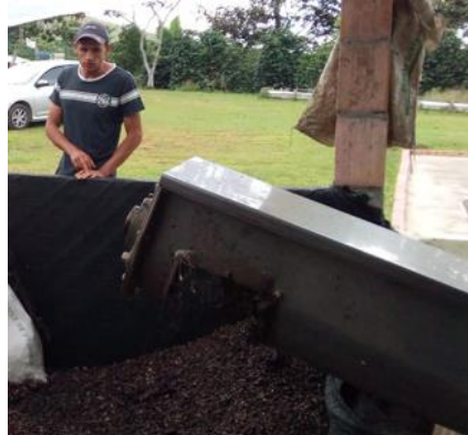
Ilustración 4. Tornillo sin fin y producto del despulpado (Propia)
